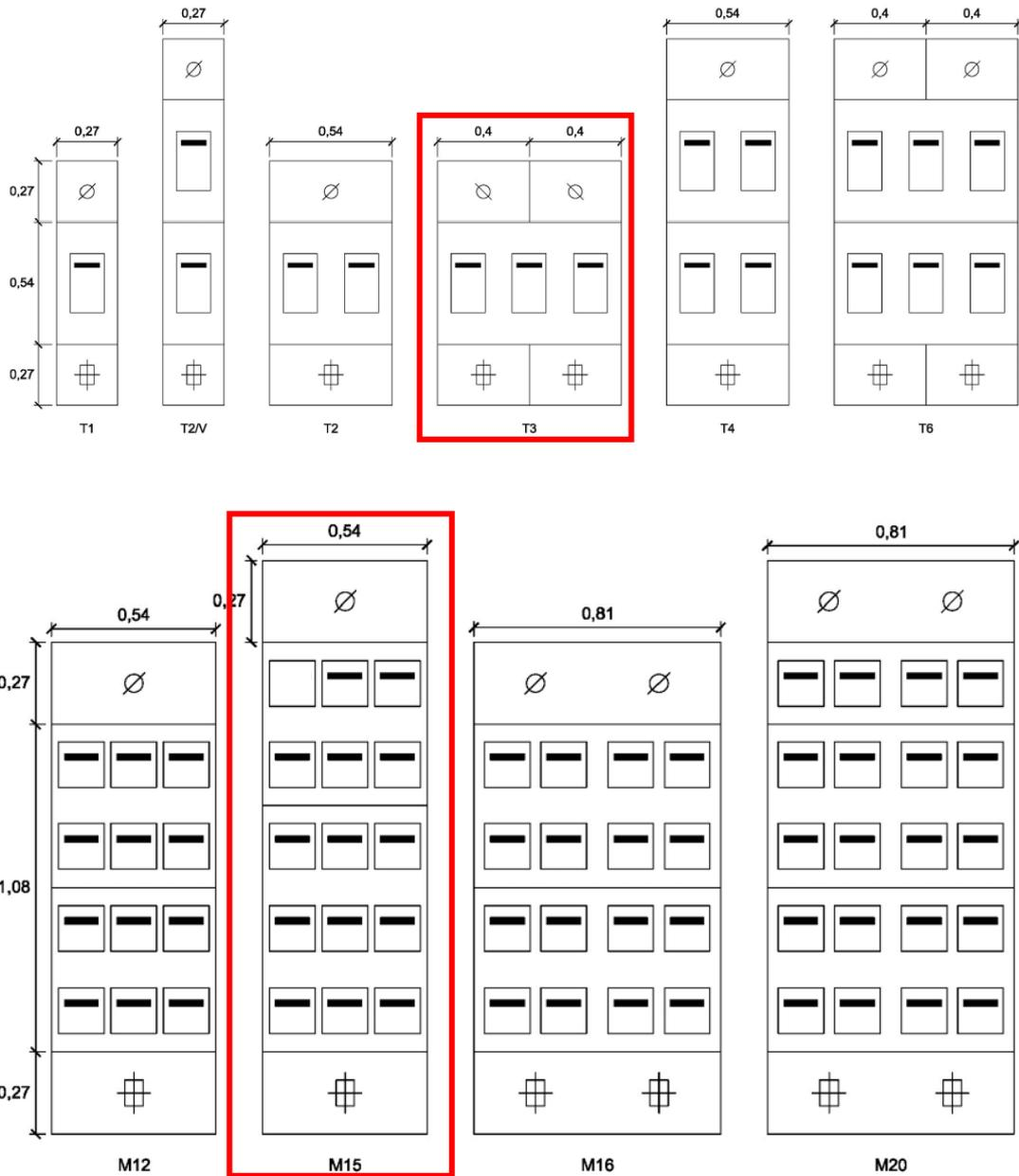
Un módulo del tipo T3 con dimensiones 0,80 x 0,27 x 1,08 m (3 contadores trifásicos) y un módulo M15 con dimensiones 0,54 x 0,27 x 1,89 m (14 contadores monofásicos y un espacio libre), en cobres de doble aislamiento modelo Himel.
